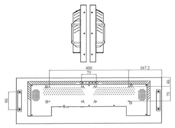
NOTE : O.D. : OUTLINE DIMENSION(mm) B.O. : BEZEL OPENING A.A. : LCD ACTIVE AREA
